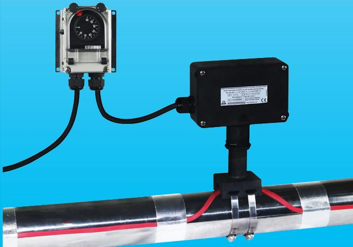
Ejemplo de montaje en dos cables de control de temperatura, con caja de distribución Y26 con soporte elevado de acero inoxidable, para protección contra congelación de tuberías.
