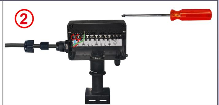
**2:** Coloque los cables de neutro y línea dentro de los terminales roscados y apriételos. Par de apriete recomendado 1,6 Nm.
