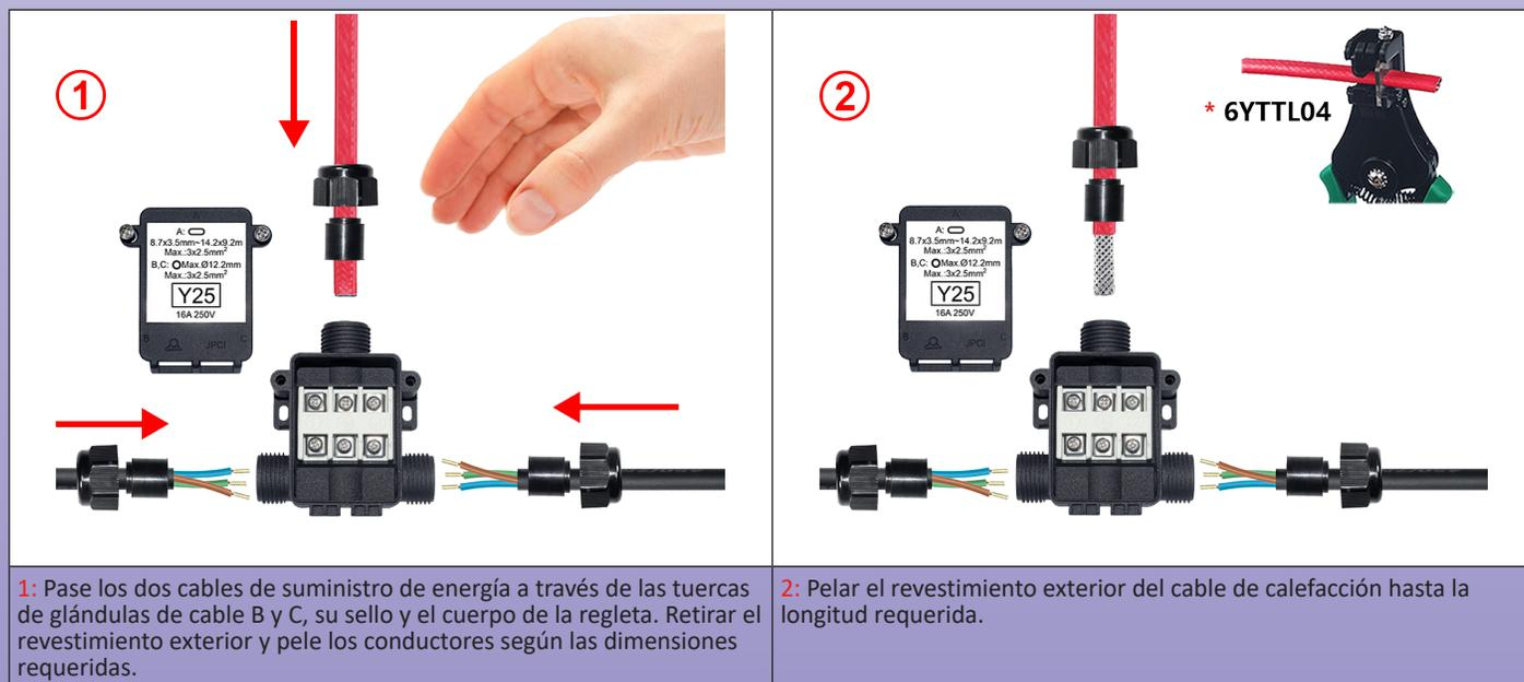
**1:** Pase los dos cables de suministro de energía a través de las tuercas de glándulas de cable B y C, su sello y el cuerpo de la regleta. Retirar el revestimiento exterior y pele los conductores según las dimensiones requeridas.
