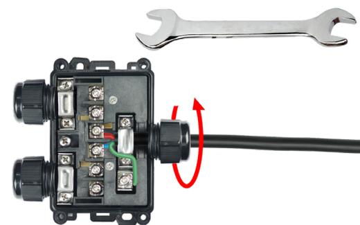
4 : Deslizar la junta de cable redondo en la glándula de cable y apriete la tuerca. Par de apriete máximo: 3 N.m.
