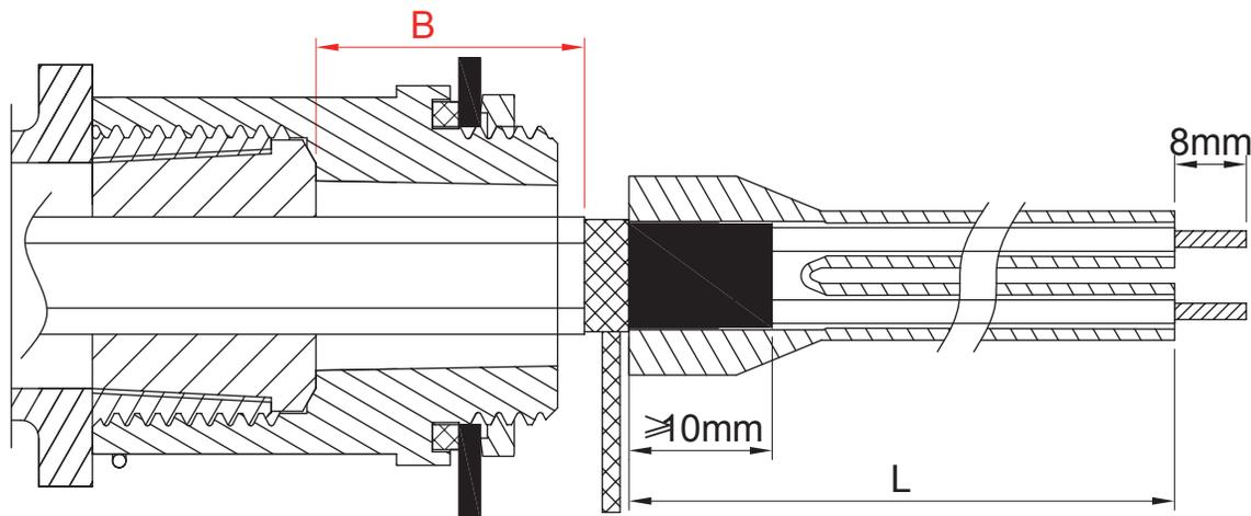
La distancia **B** debe mantenerse al mínimo para evitar el calentamiento en el interior del gabinete. La longitud **L** depende de la distancia a los terminales de conexión.
