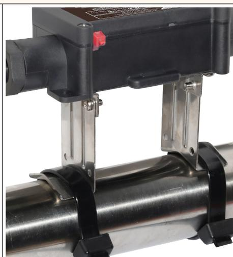
3: Un soporte de acero inoxidable, para **montaje en desplazamiento en la tubería**, que permite cerrar la carcasa después de instalar el aislamiento y su protección. Permite un espesor de aislamiento de **50 mm** y se puede utilizar en tuberías calientes. Sujeción en tuberías de metal o PVC con bridas de nailon o abrazadera metálica. (Pies disponibles como accesorio).
