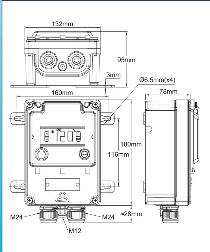
Modelo con 3 glándulas de cable (2 x M24 + 1 x M12):
