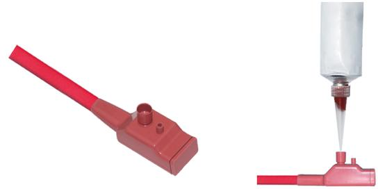
10: Coloque el ensamblaje en una superficie horizontal y llene con silicona RTV líquida a través del embudo de llenado hasta que esta silicona comience a subir en la pequeña abertura de desgasificación. Deje que cure durante aproximadamente 24 horas.
