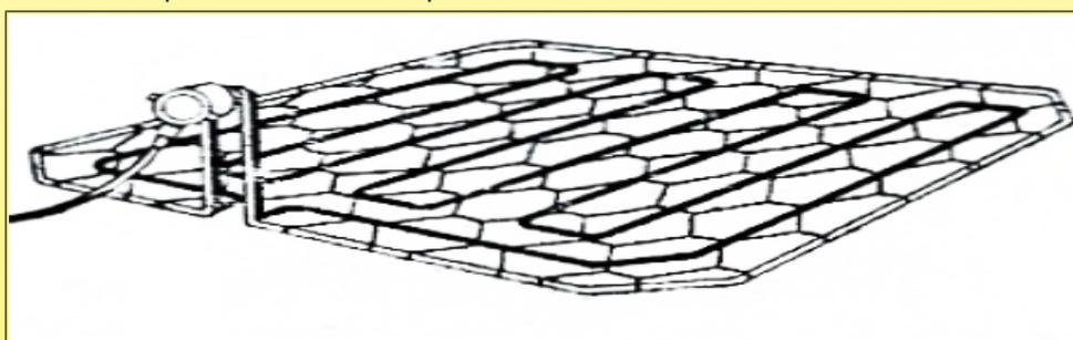
1956. ejemplo de una cuadrícula de 1,5 m<sup>2</sup>, que soporta un elemento calefactor recubierto, para capas de calefacción en horticultura. (1956 Calefacción eléctrica en horticultura, Museo Ultimheat\*)
