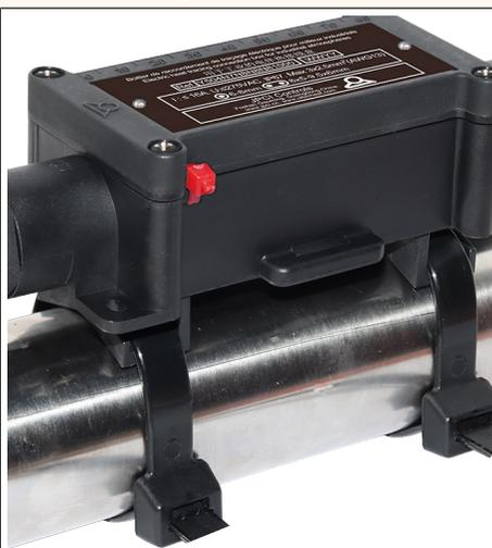
2: Dos pestañas de plástico PA66 extraíbles, para **colocar en tuberías**, proporcionando un desplazamiento de **10 mm** desde el tubo. Ideal y económico para aplicaciones con baja espesor de aislamiento y temperatura de tubería por debajo de 100 °C. La sujeción en tuberías de metal o PVC se puede hacer con bridas de nailon o abrazadera metálica, estos elementos vienen incluidos como estándar. **(Estas lengüetas se incluyen de serie)**.
