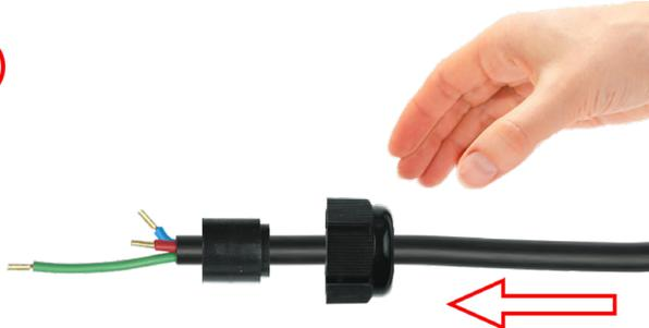
1 : Retirar el aislamiento exterior en el cable redondo según lo solicite el dibujo. Eventualmente, crimpado de zapatas de cable. Deslizar la tuerca de glándulas de cable en el cable. Seleccione la junta compatible con el diámetro y deslícela en el cable.
